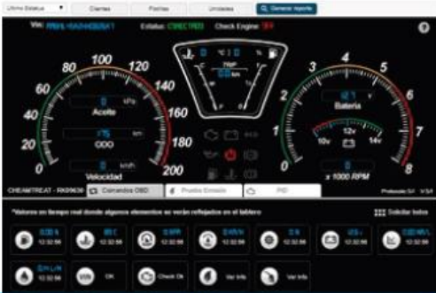
Visualización tipo DASHBOARD con indicadores de variables del vehículo obtenidos vía OBD
